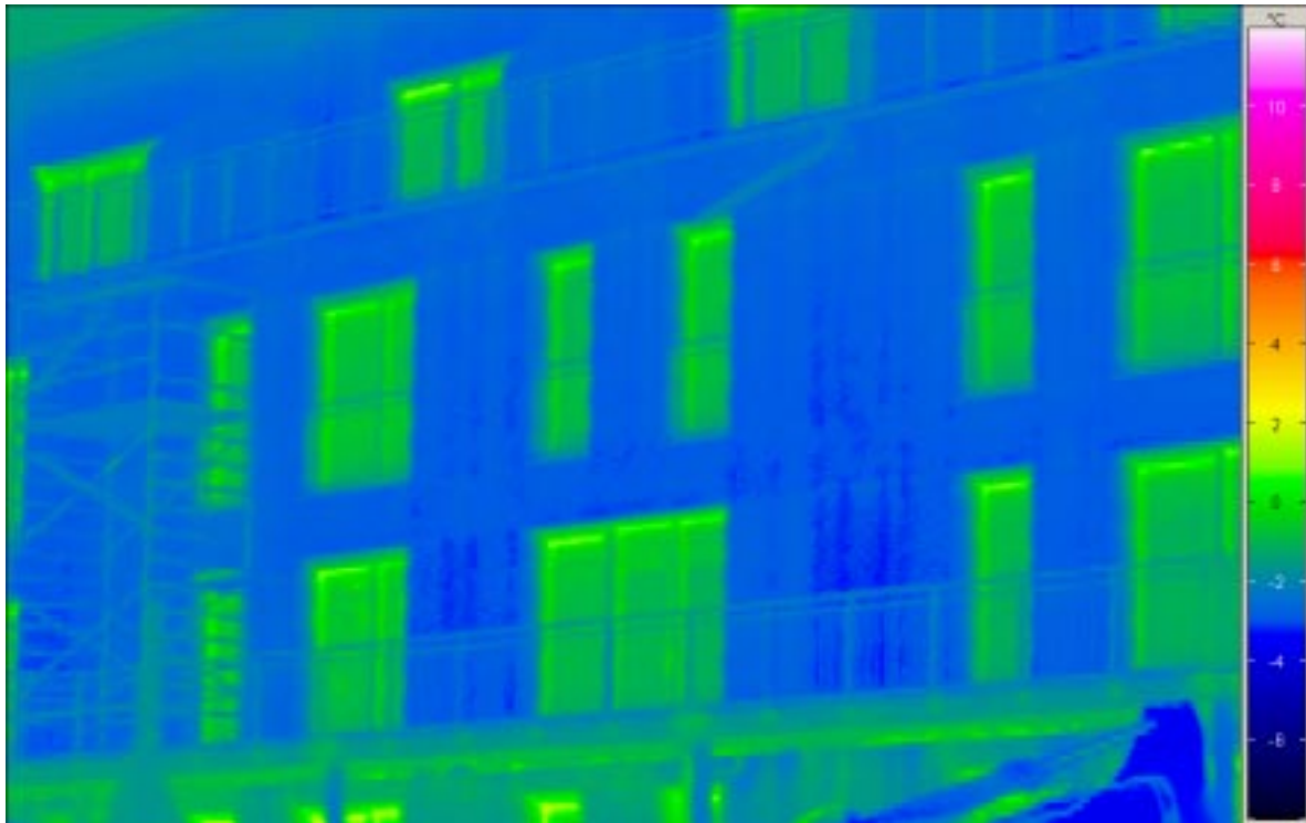
Abbildung 29: Vergrößerter Ausschnitt der Thermographie der Südfassade von Haus A. Allein der hellgrüne Streifen des Glasrandverbundes weist auf die dort höheren Wärmeverluste hin, die im Fenster-U-Wert bereits berücksichtigt wurden. Gut erkennbar sind die Metallstangen der Balkonbrüstungen.
