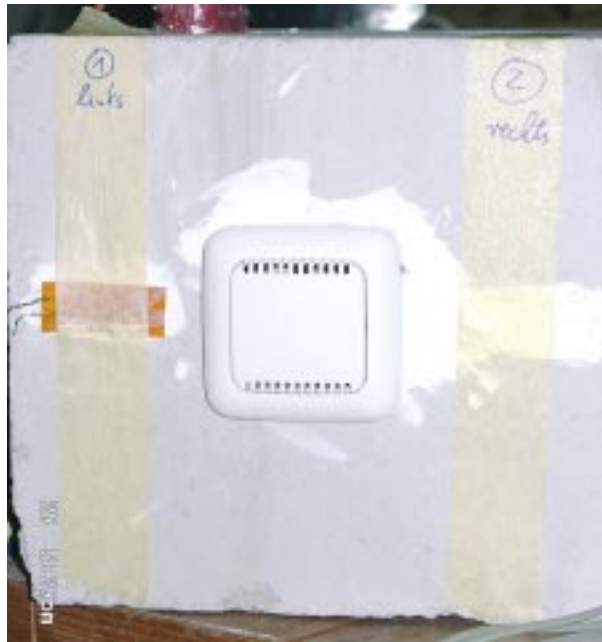
Abbildung 58: Temperaturmodul im eingebauten Zustand in einem KS-Stein für die Kalibrierung.
