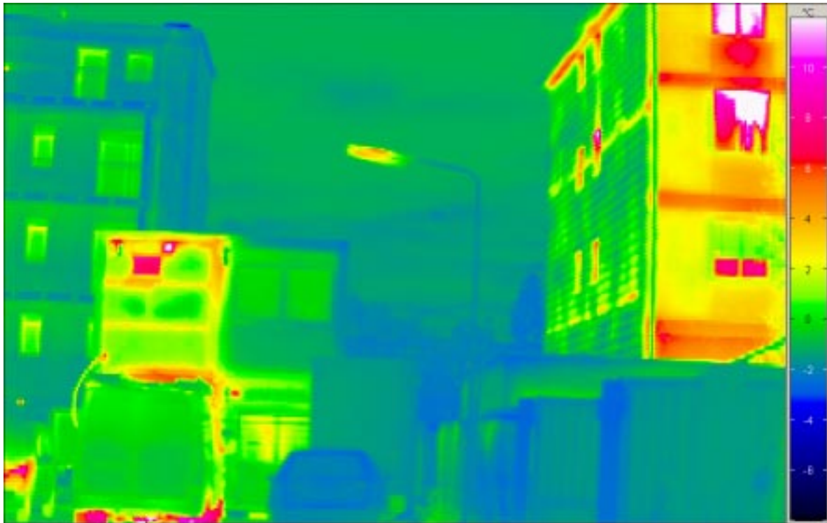
Abbildung 27: Links Haus B des gut gedämmten Passivhauses (mit Außenwandoberflächen um -2\text{ }^{\circ}\text{C} (blau), Fensteroberflächen um 0^{\circ}\text{C} ), rechts eine konventionelle Außenwand des Hospitals mit Wandoberflächentemperaturen bis 6\text{ }^{\circ}\text{C} und Fensteroberflächen über 12\text{ }^{\circ}\text{C} .
