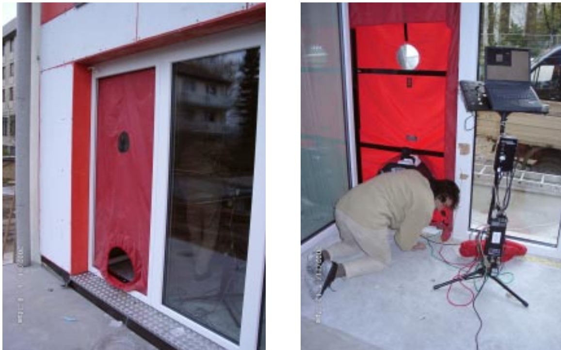
Abbildung 17: Eingebaute Blower Door in die Terrassentüren von zwei unterschiedlichen Wohnungen. Im linken Bild die Sicht von Außen mit noch fehlendem Gebläse und im rechten Bild die Sicht von innen während des Einbaues des Gebläses.
