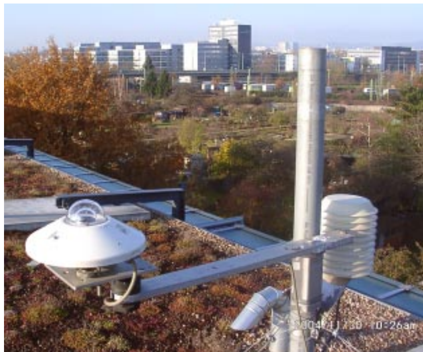
Abbildung 60: Wetterstation mit den Sensoren für Temperaturen, Feuchte und Strahlungsmessung auf dem Dach von Haus B.
