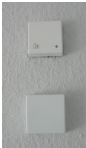
Abbildung 68: Eingesetzte Sensoren für die Luftqualitätsmessung: Relative Feuchte (oben) und CO 2 -Konzentration (unten).
