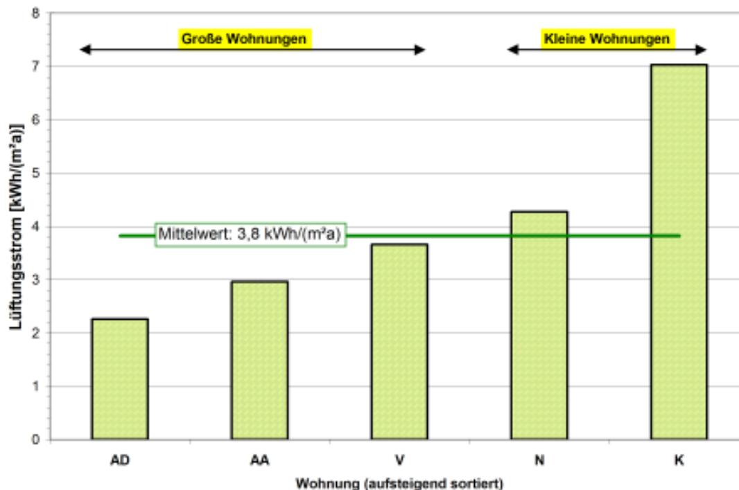
Abbildung 147: Stromverbrauch der Lüftungsgeräte in fünf Wohnungen im PHiB (Zeitraum: Zweites Bilanzjahr).
