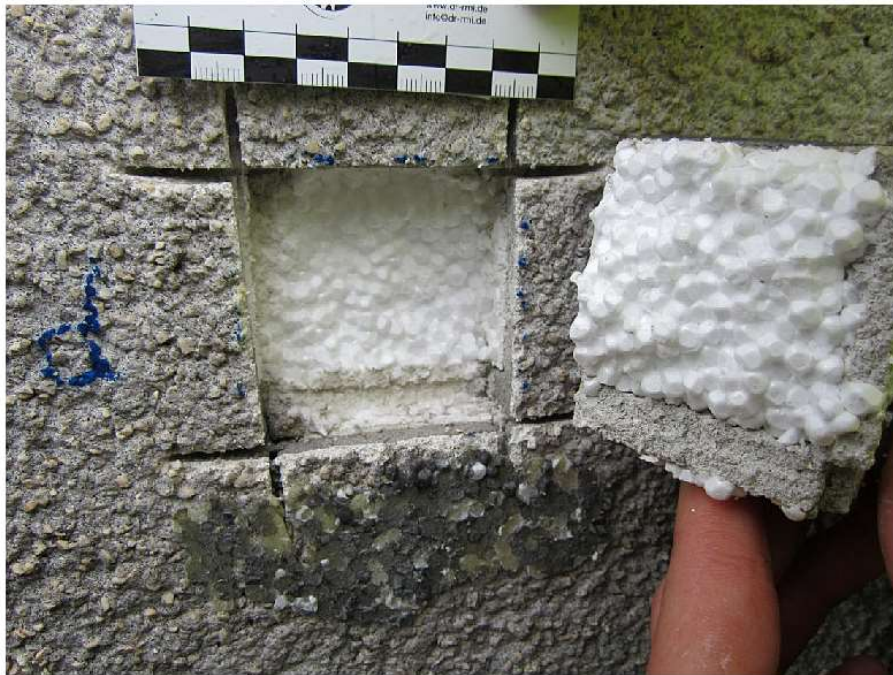
Abbildung 7: Bruchbild Probe 90042005 d
