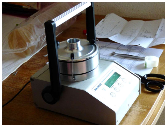
Abbildung 146: Luftkeimsammler (Impactsammler MBASS30, Fa. Hohlbach) beim Einsatz im Untersuchungsgebäude.
