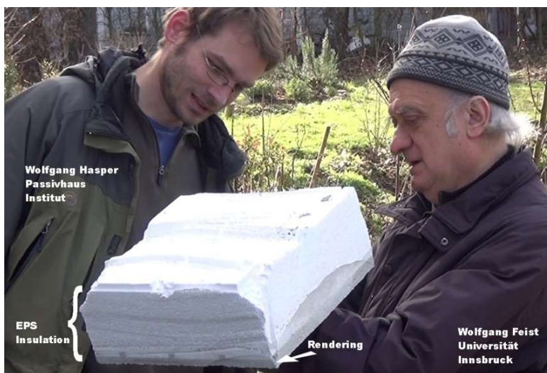
Abbildung 30: Entnommene Probe mit Putz und Dämmstoff aus der Außendämmung der Westwand des Passivhauses Darmstadt Kranichstein; der Putz ist durch und durch fest wie eine Betonplatte; der Dämmstoff erweckt visuell und haptisch den Eindruck, als ob er gerade eben verbaut worden wäre. Alle Kennwerte der Materialien entsprechen den Neuwerten. Diese Konstruktion wird problemlos weitere 25 Jahre halten.
