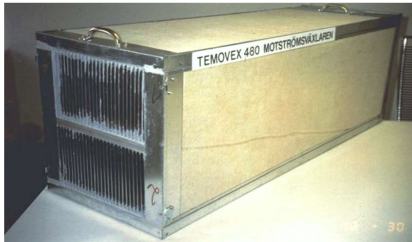
Abbildung 133: Der verwendete Gegenstrom-Luft-Luft-Wärmeübertrager für die Wärmerückgewinnung. Die Aufnahme zeigt den Blick auf das Plattenpaket von der Abluft / Zuluft-Seite. An dieser Stelle wird der Ventilatorkasten mit den beiden ECM-Lüftern aufgesetzt
