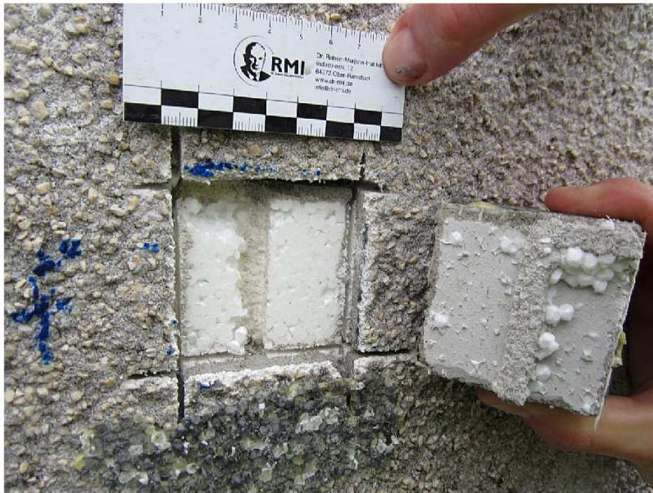
Abbildung 9: Bruchbild Probe 90042005 f
