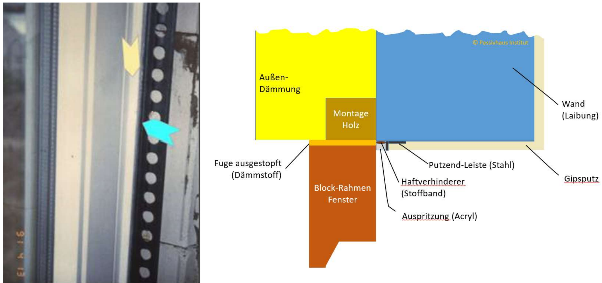
Abbildung 116: Links: Anschluss Fensterrahmen an Wand (Laibung) während der Bauphase. Die Fensterkanteln aus Holz sind luftdicht. In sie sind die Verglasungen mit einer umlaufenden Silikondichtung eingedichtet. Der Putz endet am Fenster etwa 10 - 12 mm vor dem Rahmen mit einer Anputzleiste (blauer Pfeil). Der Raum zwischen der Leiste und dem Fenster wurde mit Acryl luftdicht verfugt (gelber Pfeil). Wichtig ist, dass vor dem Verfugen zunächst ein Band zur Haftverhinderung am Untergrund eingelegt wird – die Haftung des Acryl soll ausschließlich an den beiden Flanken „Rahmen“ und „Anputzleiste“ erfolgen, damit genügend Dehnungsspiel für die Acrylmasse besteht. Rechts: Schematische Aufbauskizze der Verbindung Wand – Fenster mit Anputzleiste und Acrylfuge mit hinterlegtem Haftverhinderer.
