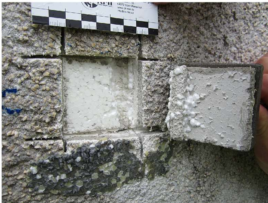
Abbildung 6: Bruchbild Probe 90042005 c
