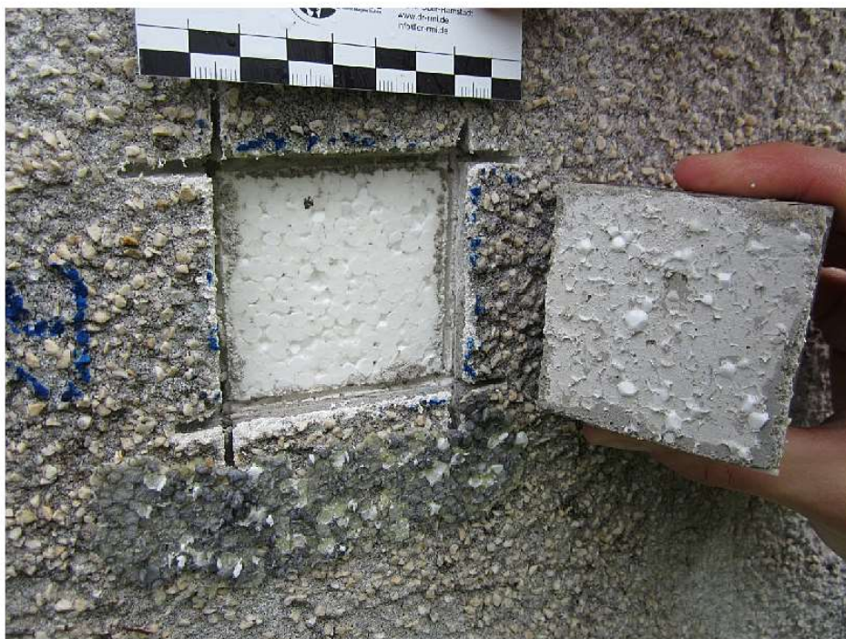
Abbildung 10: Bruchbild Probe 90042005 g
