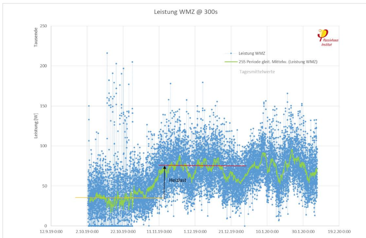
Abb. 6.: Gemessene Leistungswerte am Fernwärme-Zähler (5-Minuten Werte). Erkennbar wird der Beitrag der Raumheizung, der etwa ab dem 5.11.2019 zur Grundlast (Warmwasser und Verluste) hinzukommt.
